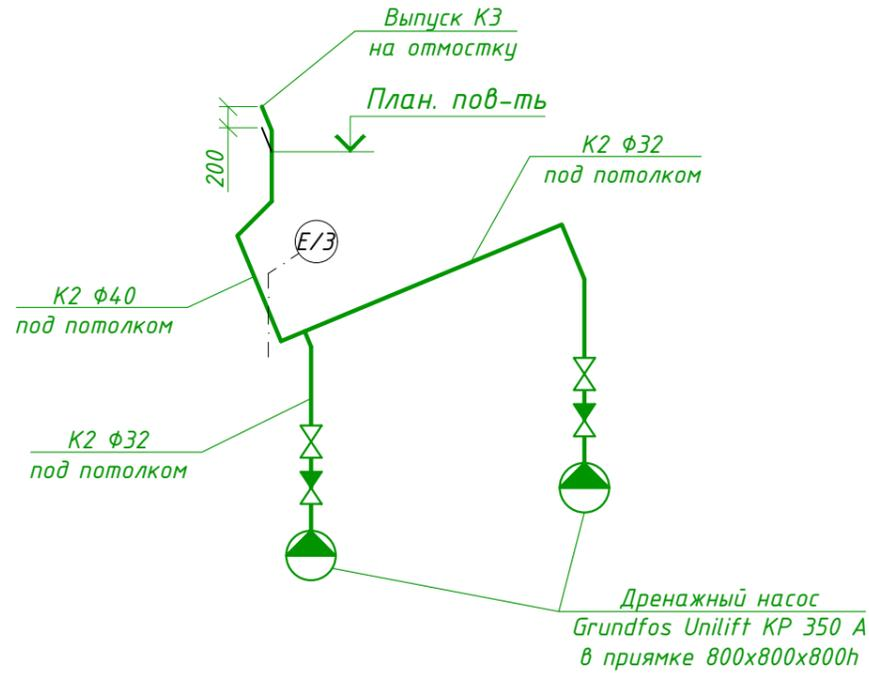
1. На схемах приведены условные диаметры трубопроводов.
