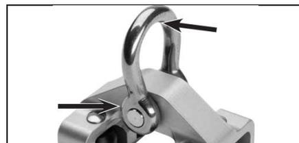
С) Резьбовую шпильку на ползунке IN212.CLEAR на предмет трещин и срыва резьбы. Замените шпильку до использования оборудования. При замене шпильки, снимите каретку с дорожки направляющей и извлеките стопорное кольцо. Выкрутите шпильку.
