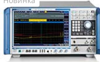
Измерительный приемник электромагнитных помех R&S ESW26
