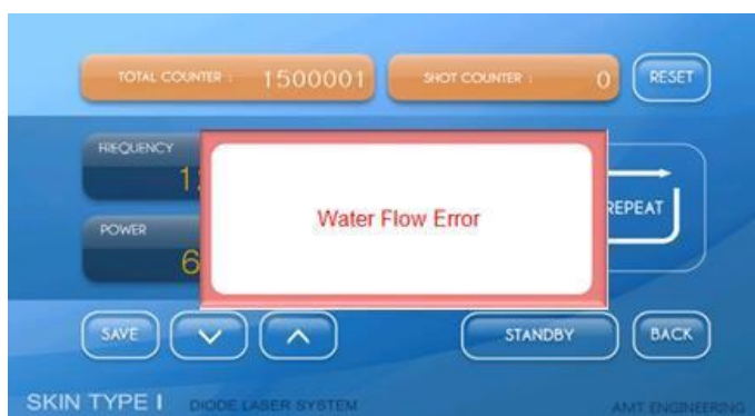
Рисунок 7.2: Ошибка системы циркуляции воды
