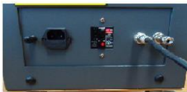
Рисунок 4.4 Все разъемы электропитания
