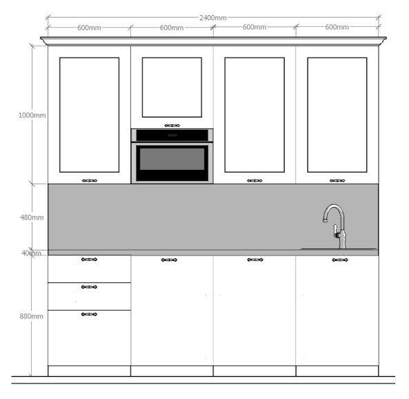
Проект-эскиз (приложение 1) к договору № от «\_\_\_» декабря 2016г. Возможна корректировка размеров после чистового замера и окончательного согласования проект
