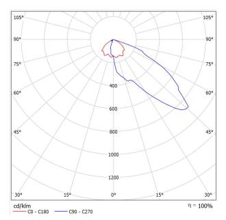
Классификация светильников по CIE: 100 CIE Flux Code: 36 80 99 100 100
