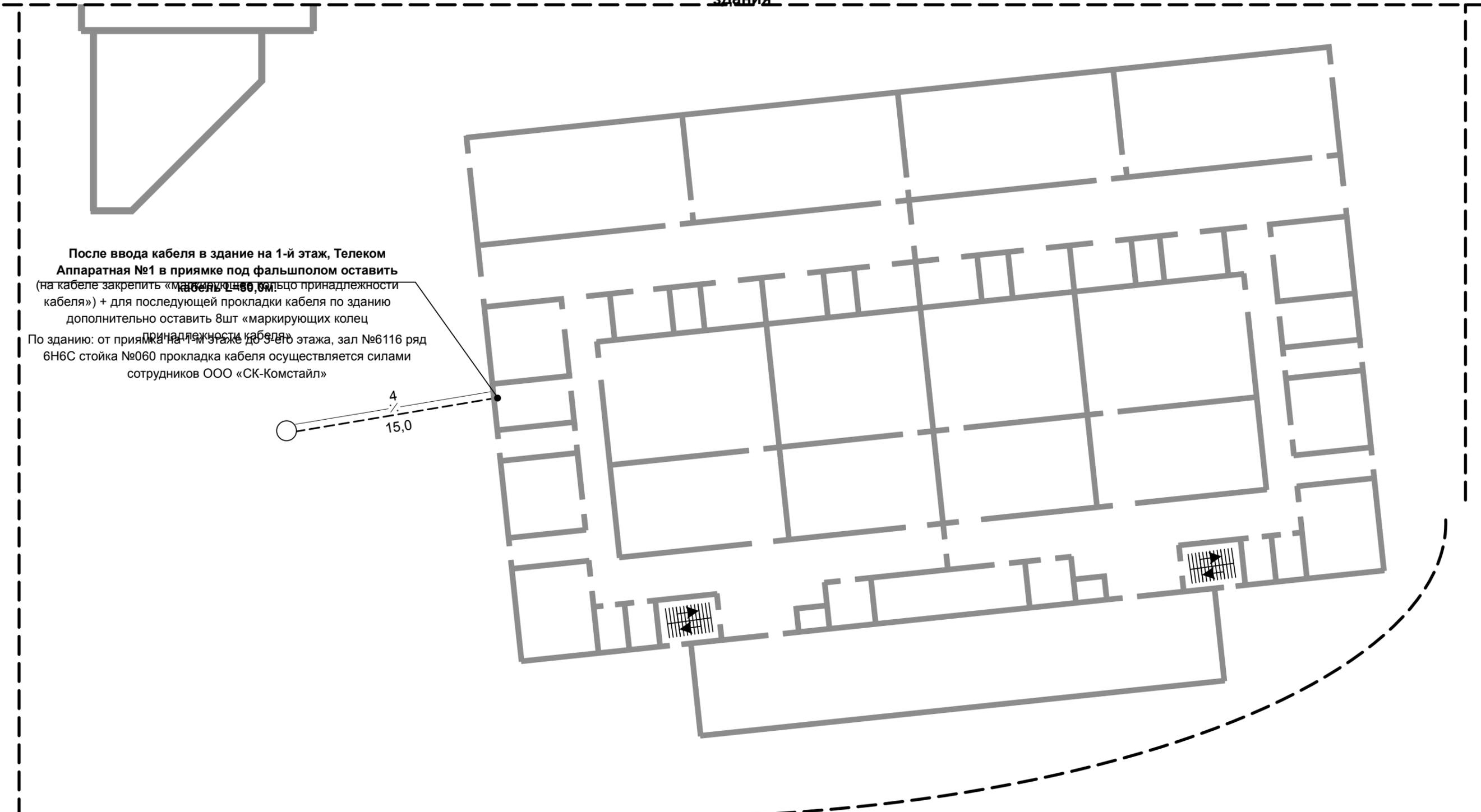
После ввода кабеля в здание на 1-й этаж, Телеком Аппаратная №1 в приемке под фальшполом оставить (на кабеле закрепить «маркирующее кольцо принадлежности кабеля») + для последующей прокладки кабеля по зданию дополнительно оставить 8шт «маркирующих колец принадлежности кабеля»
