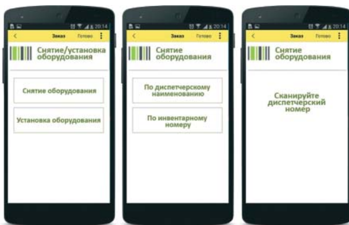
Рис. 6. Внешний вид программного интерфейса на терминале сбора данных при снятии оборудования для вывода его в ремонт
