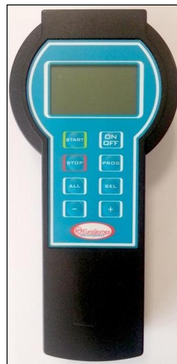
[PROG]: (ПРОГ.) Эта кнопка включает или отключает режим программирования.
