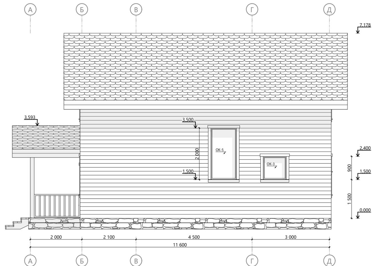
Фасад в осях 5-1
