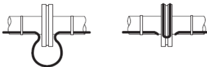
Прокладка у точки опоры труб
