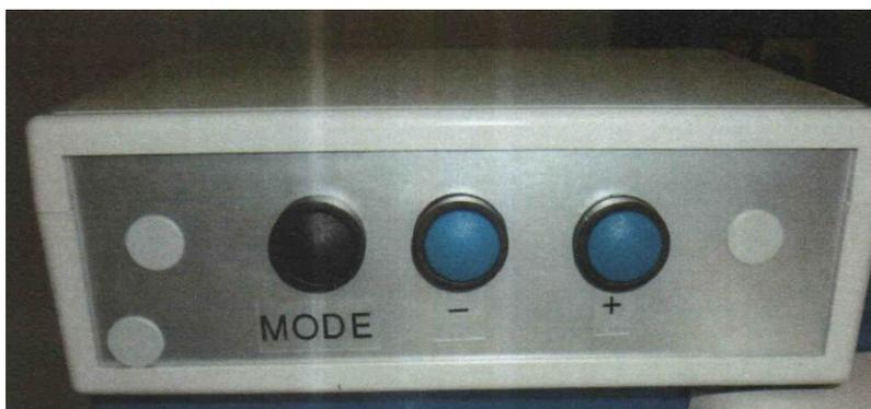
Для регулировки визира используются 3 кнопки: кнопки расположены на передней панели машины PP5.
