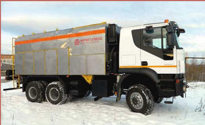
Смесительно-зарядная машина МЗУ-15-5КТ производства «НИПИГОРМАШ», оснащенная современной АСУ, предназначена для приготовления эмульсионных взрывчатых веществ для заряжания сухих и обводненных скважин на открытых горных работах. Емкости амиачной селитры и эмульсии, а также технологическое оборудование конструктивно объединены общей теплоизоляцией.
