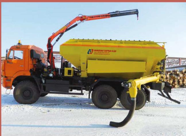
Система архивации описывает 10 различных параметров, таких как номер карьера, номер блока, номер машины, масса заряда, развесовка компонентов; рецепт, на котором производилось заряжение; вся информация может быть перенесена на USB-носитель (флэш-накопитель). Помимо этого, в АСУ СЗМ предусмотрена функция регулирования производительности машины, обеспечивающая заряжение скважин диаметром от 105 мм и более.
