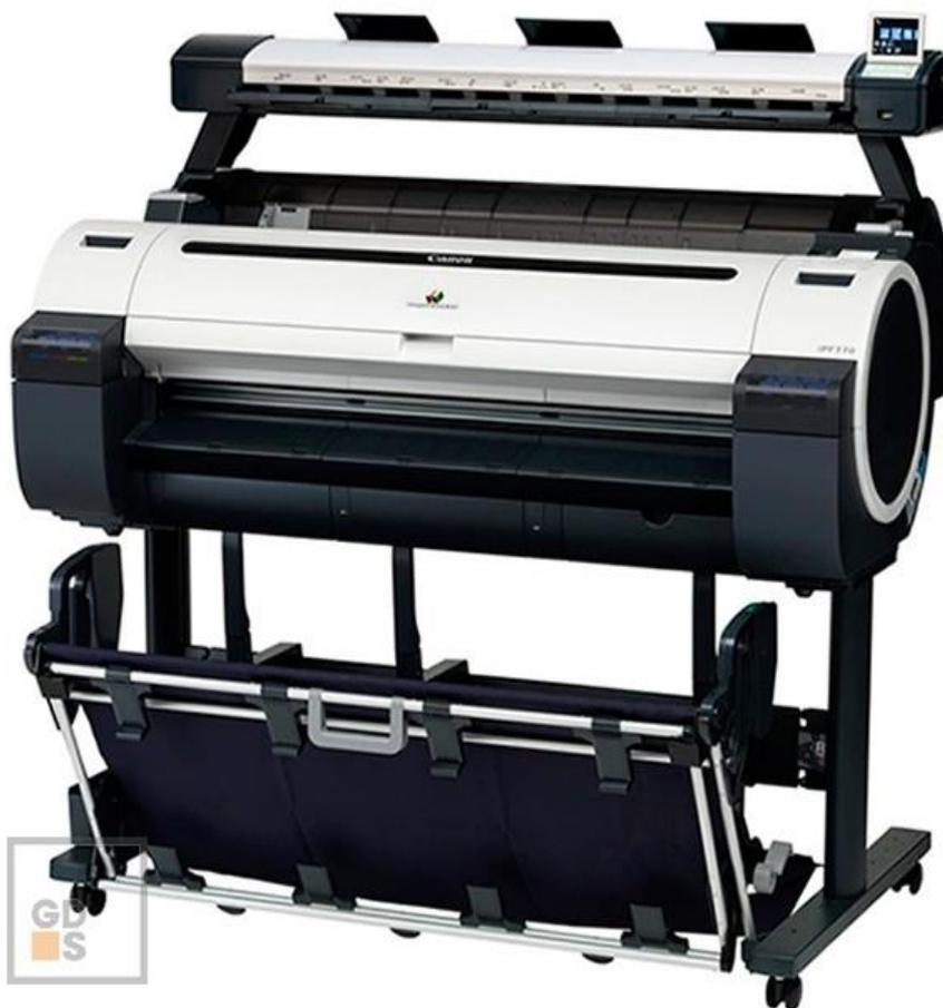
По техническим возможностям и способу создания изображения плоттеры бывают лазерными и струйными. Принцип работы струйного принтера основан на использовании в печати жидких чернил. С помощью головки, наполненной чернилами и перемещающейся по ширине листа от края к краю, наносится часть создаваемого изображения. Затем бумага перемещается на заданное расстояние, после чего печатается следующая часть. И так пока изображение не будет напечатано полностью.
