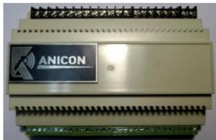
Рисунок 1. – Контроллер системы промышленной автоматизации для сферы ЖКХ (полный цикл проектирования. ПО – Altium Designer. Составные части и компоненты: радиомодемы собственной разработки для 433 и 868 МГц, автоматическое конфигурирование, множество аналоговых и цифровых входов и выходов, ШИМ, вход 4...20 мА, 0...10 В, переключаемые для ряда входов режимы работы с платиновыми термометрами, RS485, самонастраивающаяся топология сети, поддержка модулей Wi-Fi и BT, открытая архитектура. Разработано встроено и серверное ПО)
