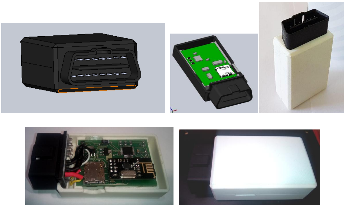
Рисунок 5. – Сканер автомобильного диагностического комплекса «ОраКар» (Разработка прототипов с «нуля» для заказчика «под ключ». Презентация: https://aniconrus.ru/data/documents/Prezentaciya_ORACAR_3.pdf )
