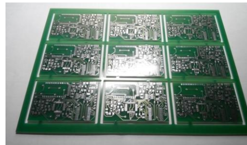
Рисунок 2. – Система двухдиапазонного (433/868 МГц) радиообмена с уплотнением каналов (основа – Odroid C2, разработана кросс-плата с источником питания, настройкой режимов, индикацией, элементами управления, поддержкой LAN, USB, RS485, UART. Разработано ПО для ОС Linux)
