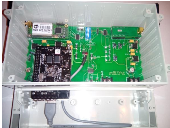
Рисунок 2. – Система двухдиапазонного (433/868 МГц) радиообмена с уплотнением каналов (основа – Odroid C2, разработана кросс-плата с источником питания, настройкой режимов, индикацией, элементами управления, поддержкой LAN, USB, RS485, UART. Разработано ПО для ОС Linux)
