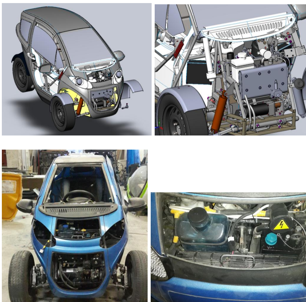
Рисунок 4. – Проектирование узлов электромобиля «BravoEgo» (длительное участие нашего сотрудника в данном проекте. Моделирование, механические, тепловые и аэродинамические расчеты, штамповка, литье, фрезерование, отливка по моделям)
