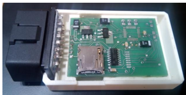
Рисунок 3. – Сканер системы автомобильной диагностики (полный цикл разработки. Основа – микроконтроллеры ATmega, поддерживаются протоколы CAN, K-Line, BT, nRF. Встроена поддержка SD. Сопровождение промышленного выпуска. Разработка ПО)
