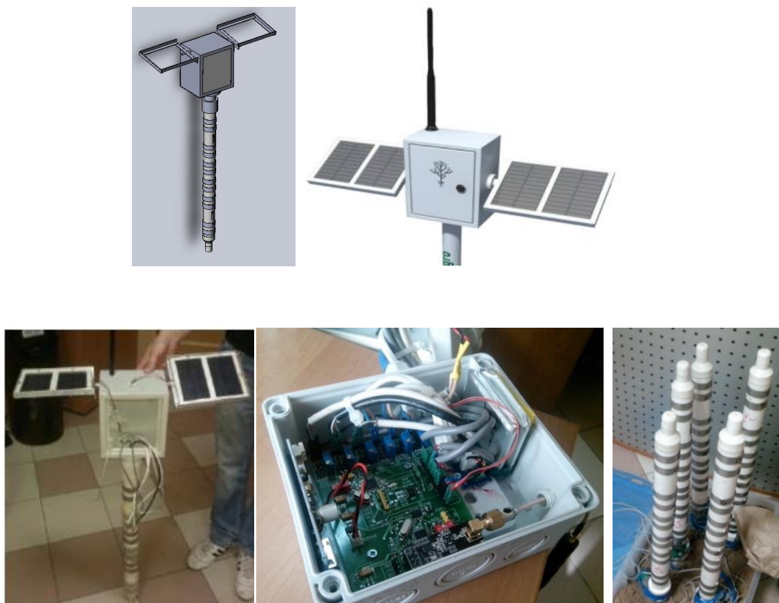
Рисунок 2. - Прототипирование почвенной измерительной станции для системы точного земледелия (Презентация: https://aniconrus.ru/data/documents/SmartAgro_2017.pdf )
