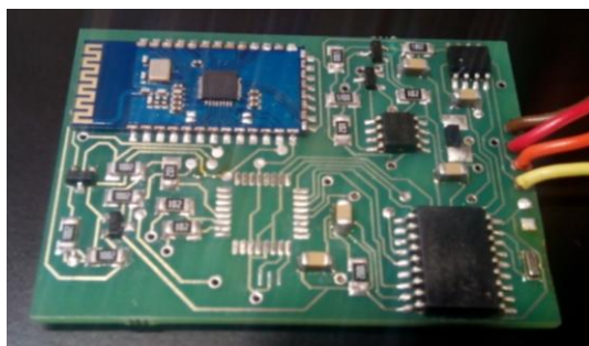
Рисунок 3. – Сканер системы автомобильной диагностики (полный цикл разработки. Основа – микроконтроллеры ATmega, поддерживаются протоколы CAN, K-Line, BT, nRF. Встроена поддержка SD. Сопровождение промышленного выпуска. Разработка ПО)
