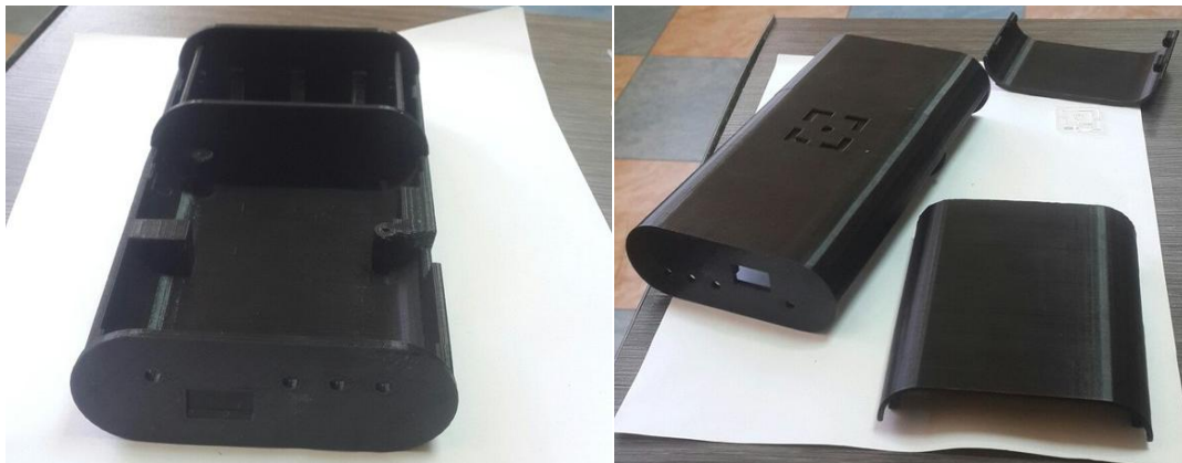
Рисунок 7. – Разработка носимого мультдиапазонного шлюза дальней связи (весь цикл разработки прототипа, на рисунке: моделирование и 3D-печать корпуса).
